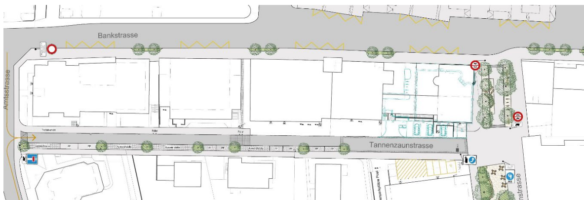
Ausbau Tannenzaunstrasse mit Neuordnung Parkplätze und Ausweichstellen
