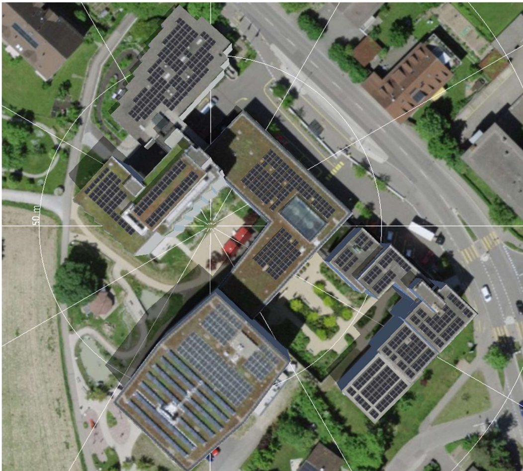
Abbildung 3: Modullayout Photovoltaikanlage Alters- und Spitexzentrum Dübendorf
