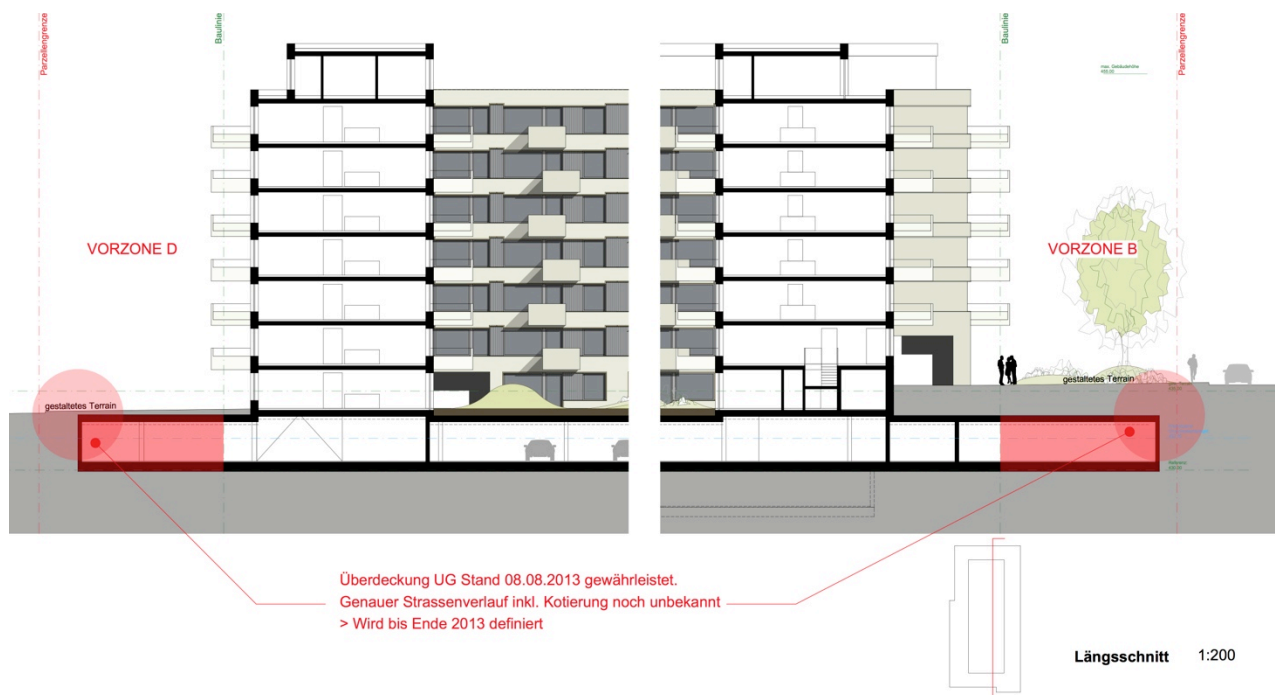
Längsschnitt Vorzone D – Vorzone B (Richtprojekt)
