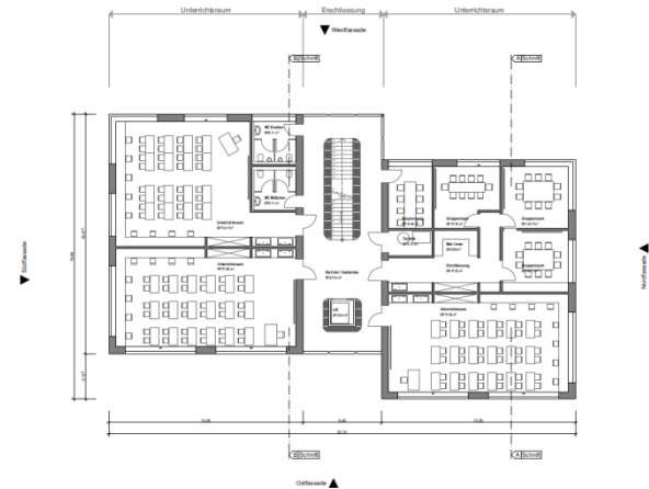
Regelgeschoss Primärnutzung als Klassenzimmer
