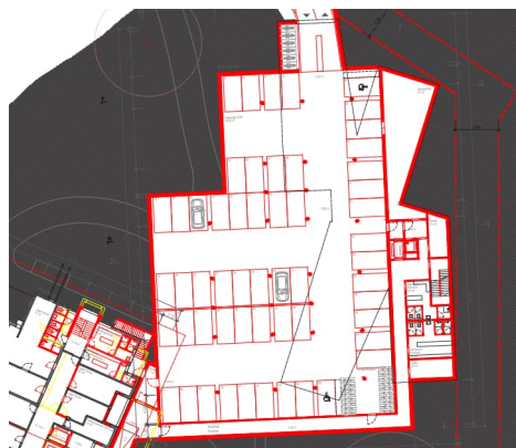
Abbildung 13 Beibehalt des UGs von Haus C (links unten) und flächenminimal eingepasste Einstellhalle gemäss Richtprojekt von Diener & Diener Architekten
