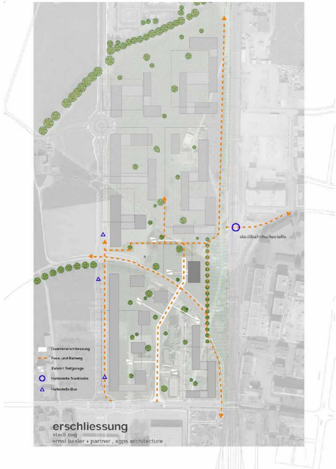
Abbildung A2-1: Erschliessung gemäss Quartiergestaltungsplan (Erläuterungen)
