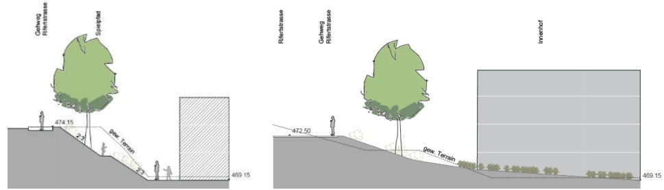
Abb. 15 – Prinzipien Böschungsgestaltung (Quelle: Burckhardt + Partner AG, 2020)
