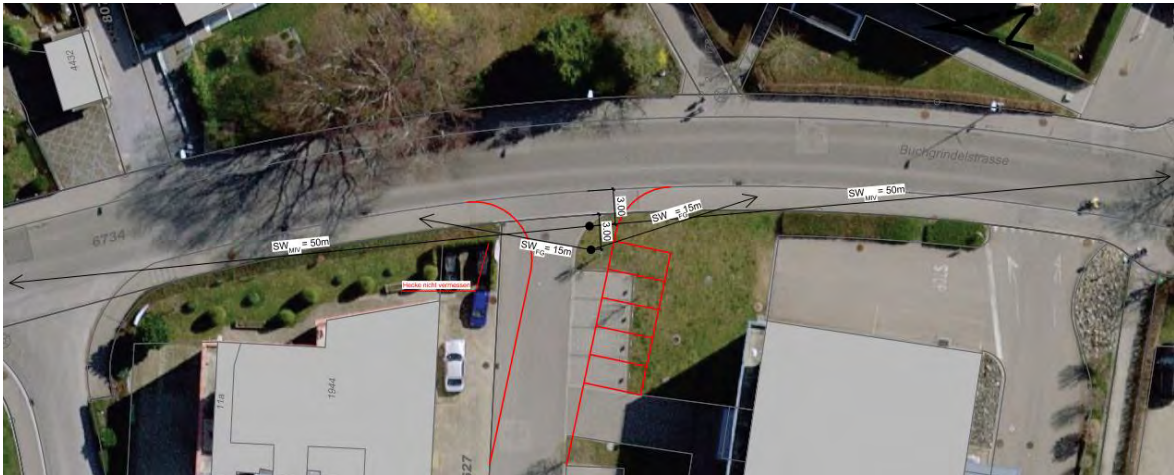
Abbildung 4: Situation Einmündung 3 mit Sichtweiten
