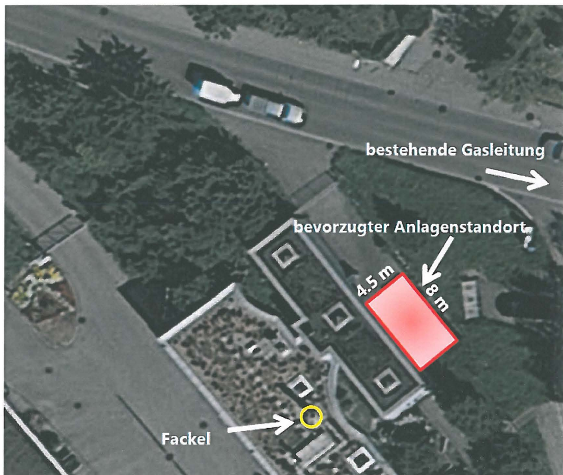
Abbildung 2: Standort der Biogasaufbereitungsanlage auf dem Gelände der ARA Flos
