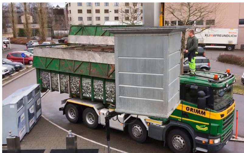
Entleerung von Unterflurcontainern für Glas (Grün, Braun, Weiss) und Alu/Weissblech an der Quartiersammelstelle Pappelstrasse.
