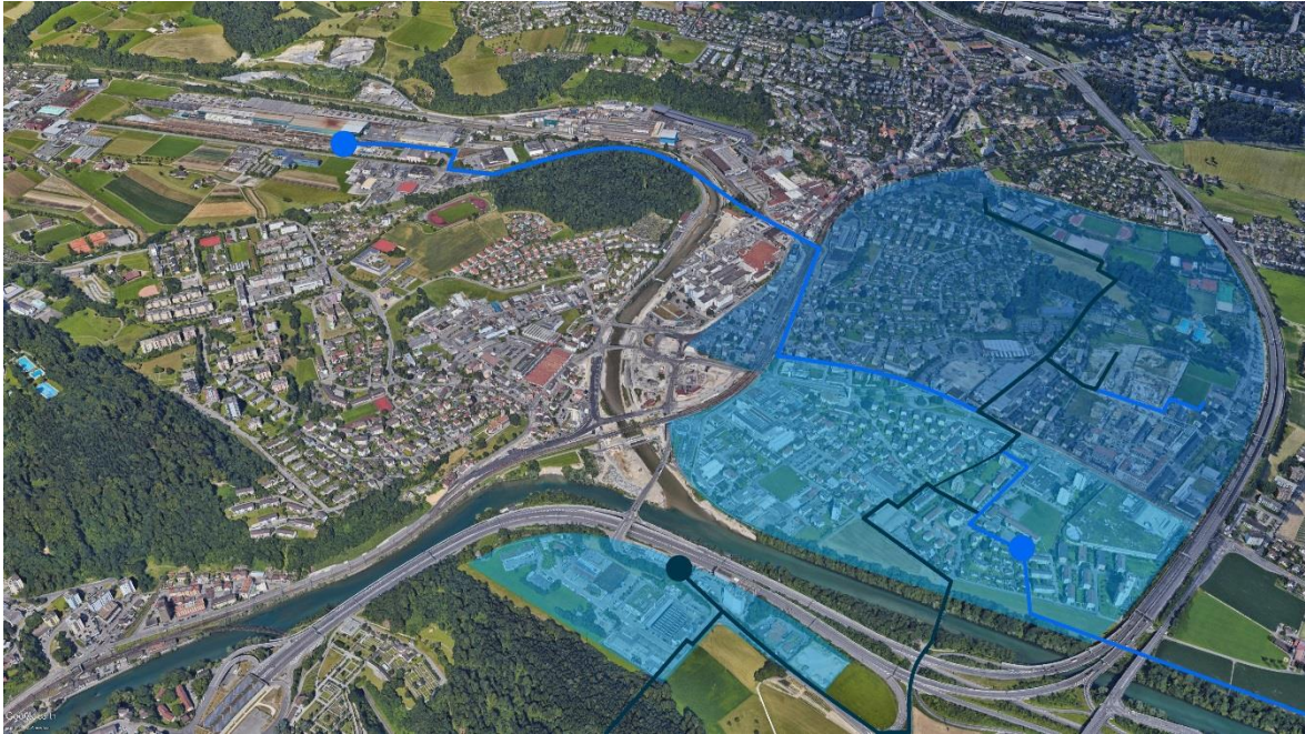
Abb. 1: schwarz: bestehende Hauptleitung ab KVA Ibach, blau: neue Leitungen ab Wärmeübergabestation Emmen
