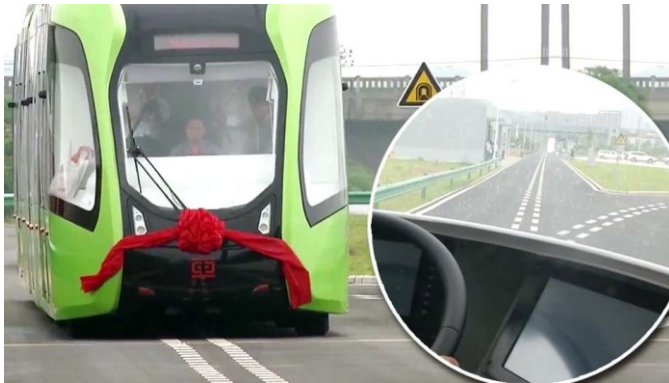
Abbildung spurgeführtes Pneu-tram (entwickelt in China)
