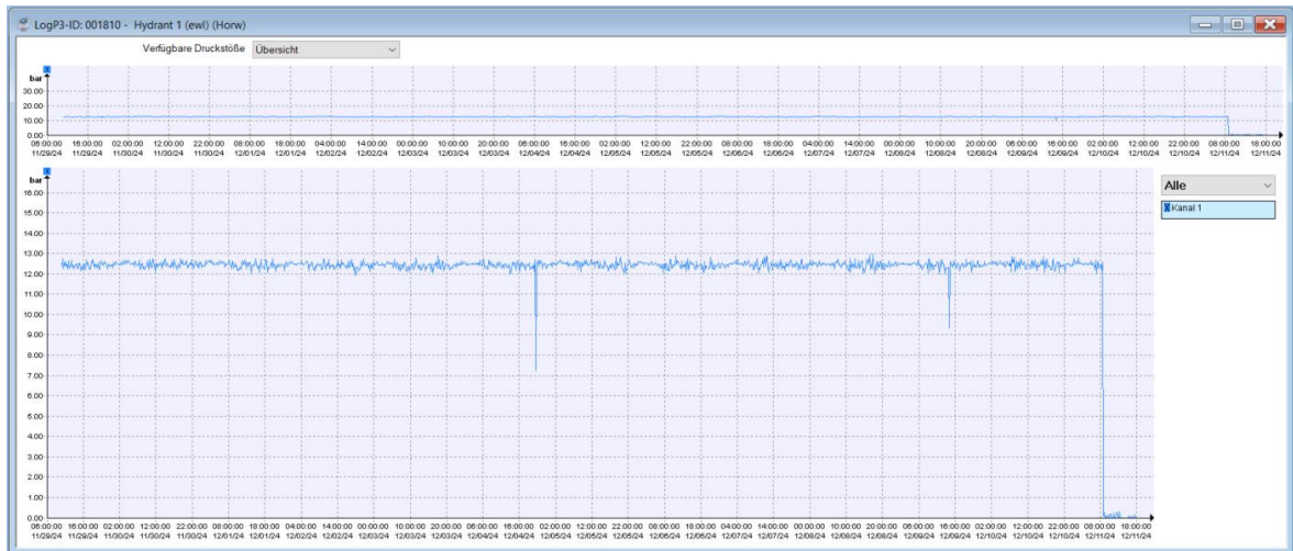
Abbildung 11: Druckmessung am Hydranten vom 29.11. bis 10.12.2024
