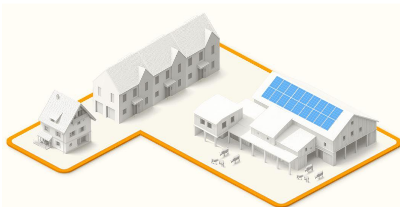
Abbildung 3; Schema virtueller Zusammenschluss zum Eigenverbrauch (vZEV)
