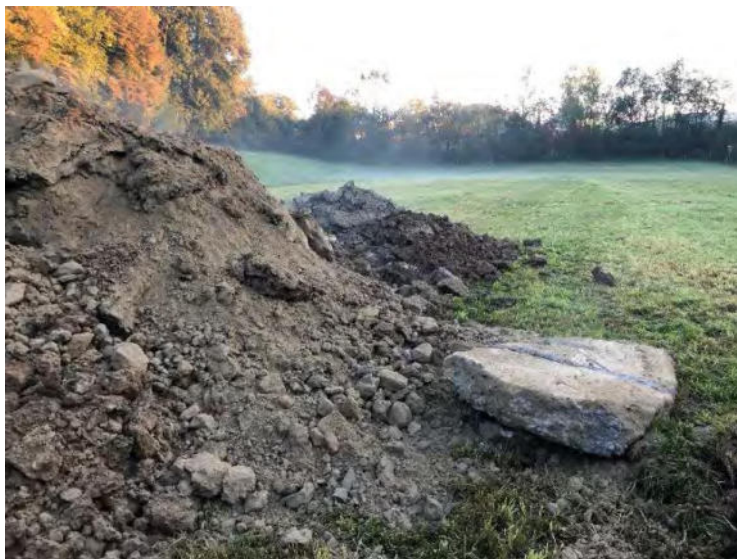
BS 1: Mittel- bis grobkörniges Material, vereinzelt grosse Betonbruchstücke Blickrichtung N
