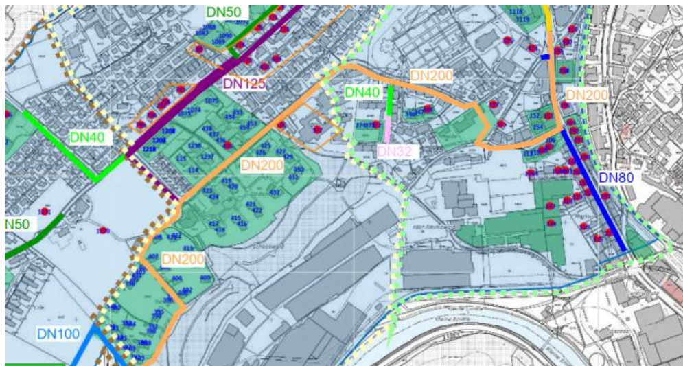
Abbildung 16: Übersicht geplanter Ausbau Fernwärme Emmen
