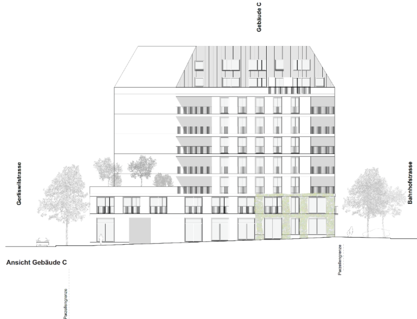
Abbildung 7: Ausschnitt Richtprojekt Fassadenbegrünung
