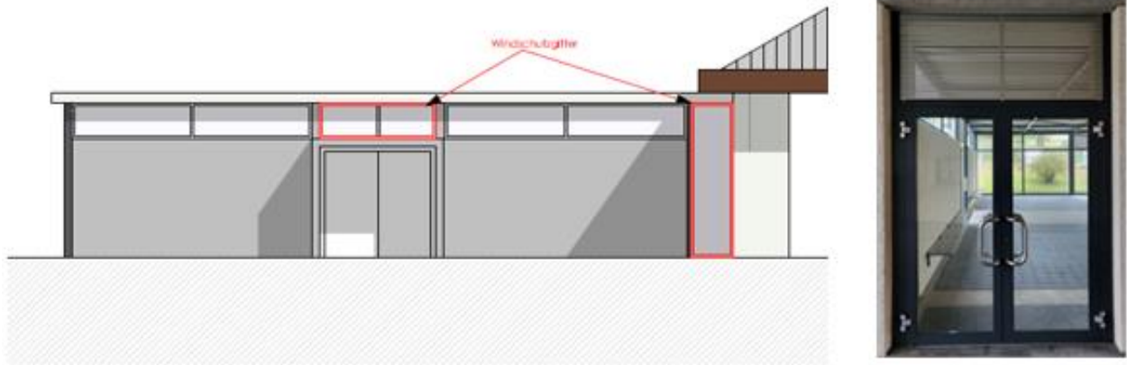
Abbildung 25; Seitenansicht Abdankungshalle und bestehende Lüftungsschlitze
