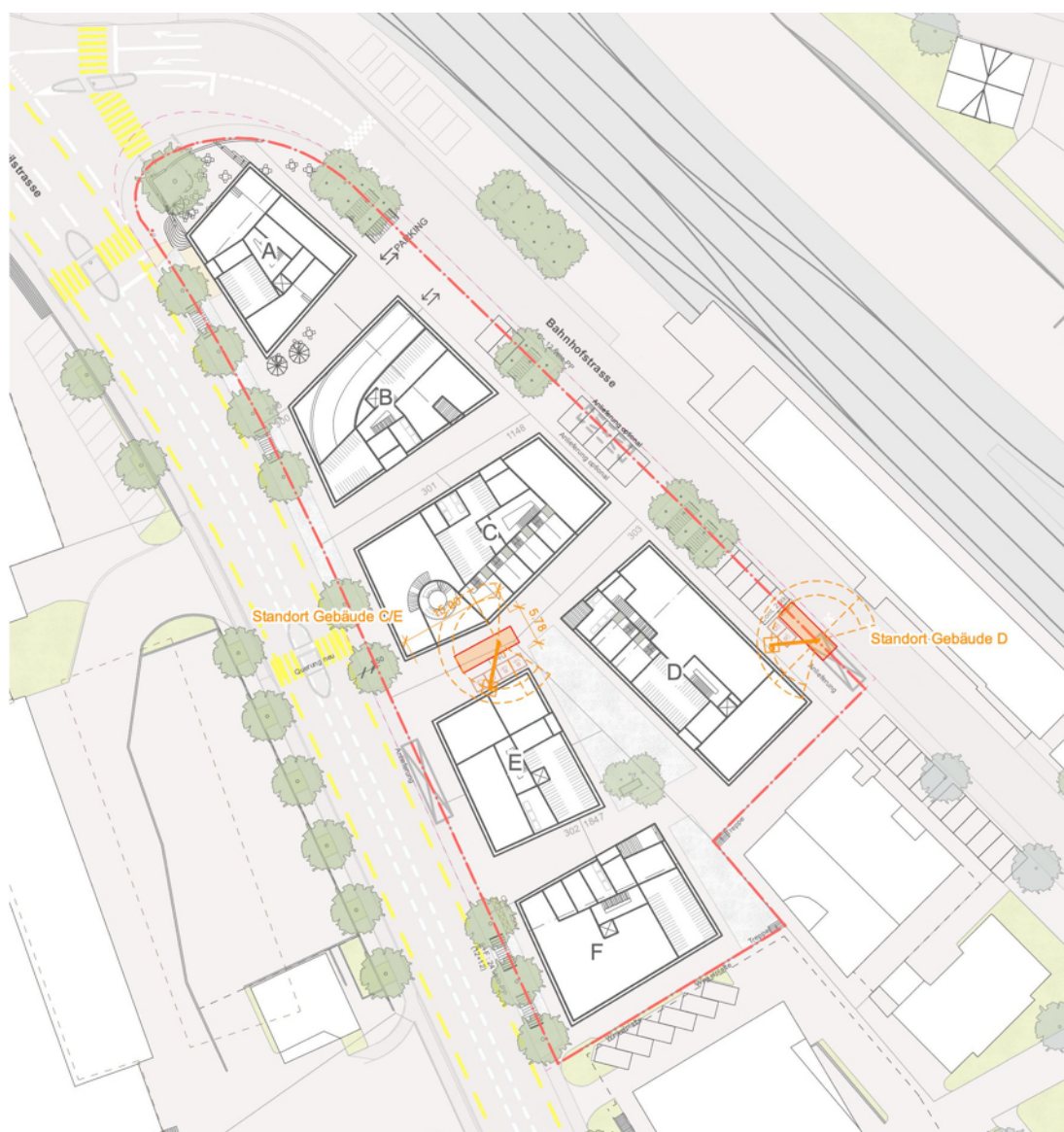
Abbildung 2: Standorte Entsorgung im Bebauungsplanperimeter (Grundlage: Richtprojekt)
