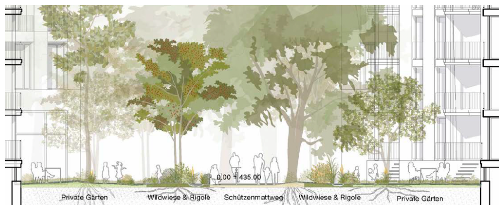
Abb. Schwammstadt-Prinzip mit Rabatten, Rigole an den Wegen/Fassaden
